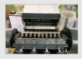
宝绿特粉碎机可在粉碎过程中加入水,让瓶片在粉碎时起到摩擦清洗的作用,同时用水可以达到降低粉碎室内温度,减少刀具磨损,最重要的是它降低粉末的产生,减少瓶片生产的损耗量,同时为后段瓶片热清洗创造条件。
